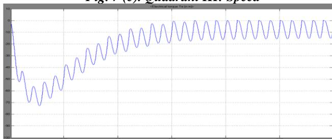
**Fig. 7 (d). Quadrant III: Electromagnetic torque**
